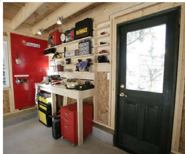
構造材を利用して作った棚と作業台。シンプルながら、愛用の工具がきれいに置かれている
